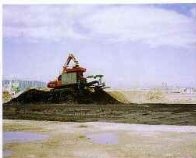
【大きなガレキは破砕機により80mm以下に破砕】
