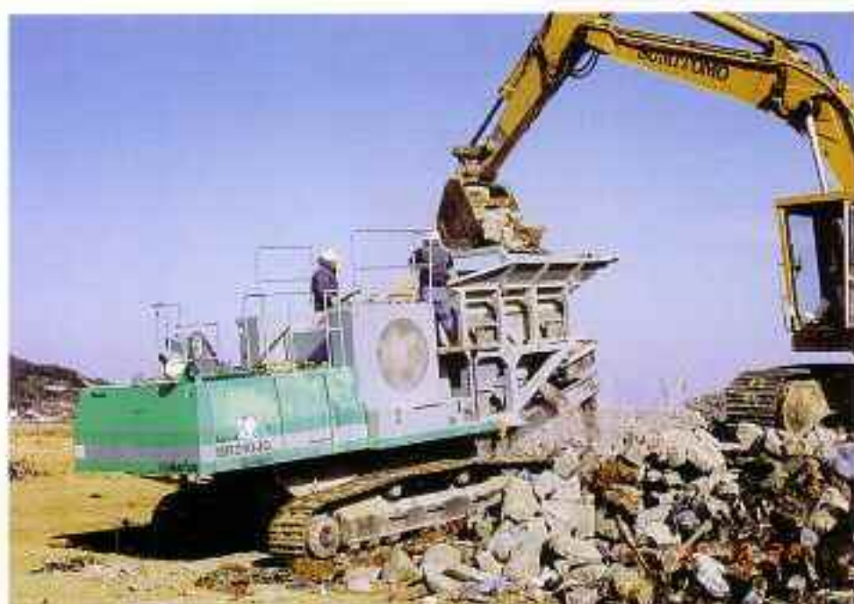
【破碎施設（150mm以下に破碎）→海面埋立】
