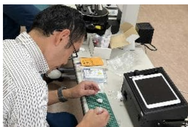
携帯型蛍光顕微鏡によるアスベストの漏洩確認
