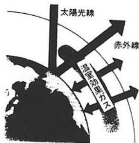
地表面から反射された赤外線エネルギーの一部は大気中の温室効果ガスに吸収され地表を適度な温度に保っている。
