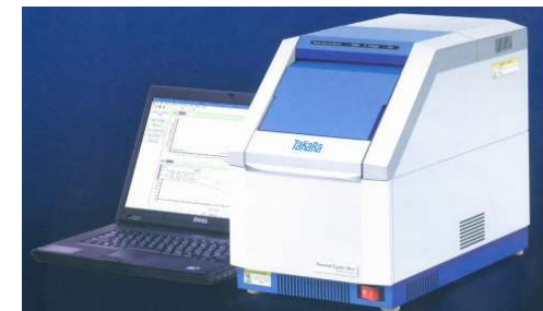
環境DNAの分析に用いる PCR検査装置
