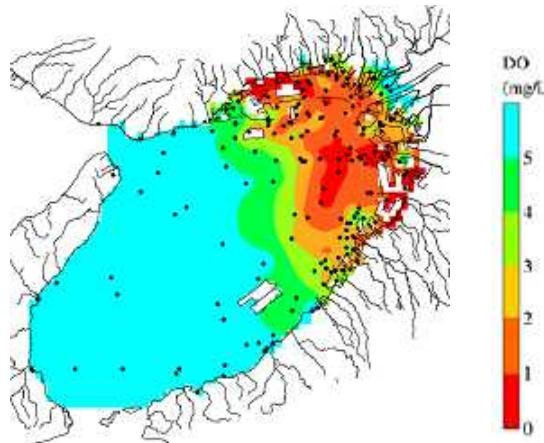
図 2-42 底層の溶存酸素量 (DO) の水平分布図 (令和4年度)
