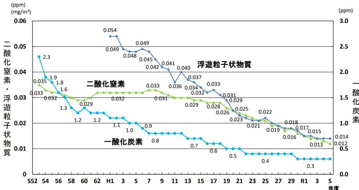
図2-57 自動車排出ガスによる大気汚染の推移
