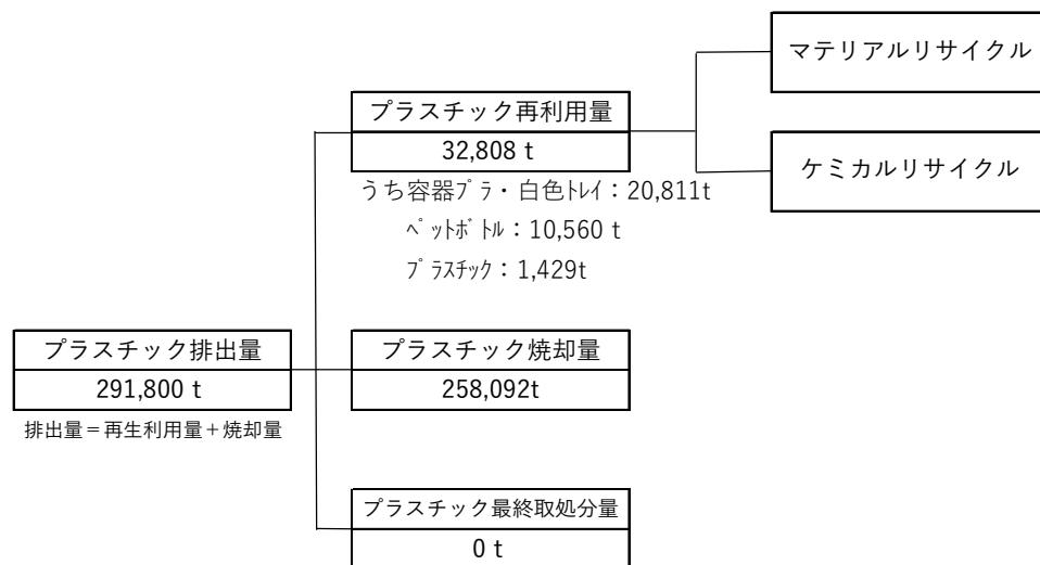
23 図2-52 一般廃棄物のプラスチック処理フロー
