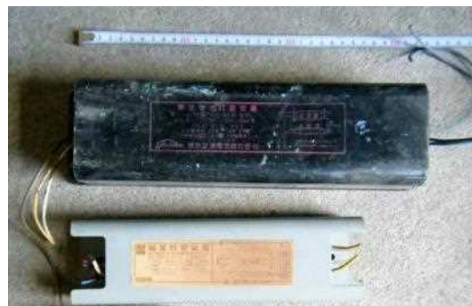
PCB 油含有廃安定器
