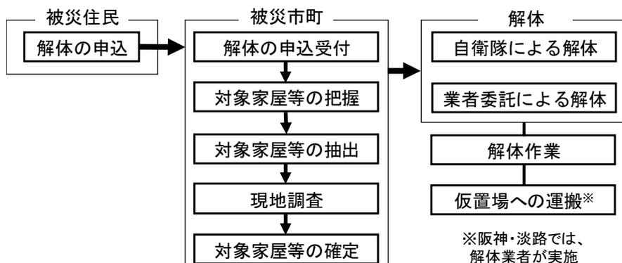
図3-4 被災建物の解体・撤去フロー
