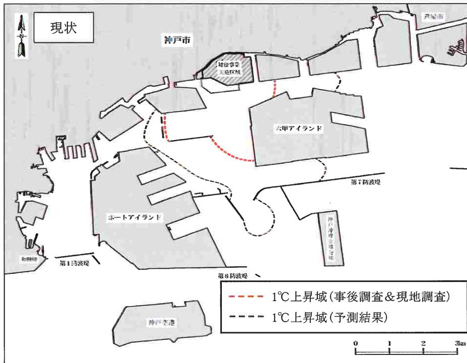
図 2(1) 平面 2 次元モデルで予測した既設設備の 1℃以上上昇範囲の予測結果と事後調査及び現地調査結果（現状）
