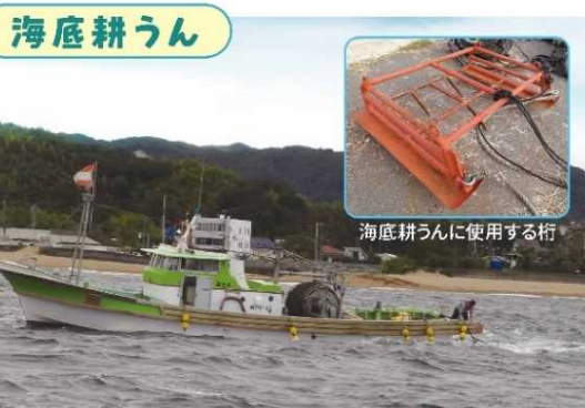
海底耕うん 底質環境を改善するため、漁業者が小型漁船で爪のついた専用の桁(けた)をひき、海底を耕す。海底を柔らかくして、底生生物が生息しやすい環境をつくり、沈殿した栄養分を海中にまきあげる
