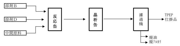
5. ラノリン製造フローシート (廃溶媒発生工程) (酸性廃水発生工程)
