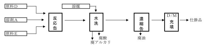
3. 反応缶洗浄・試作工程フロシート
