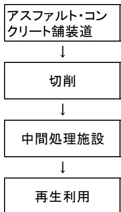
がれき類(アスファルト・コンクリート殻)→收集運搬→破碎→再生利用
