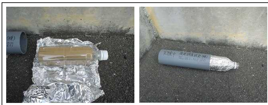
写真2-2-1 . コロニー捕獲用人工巣の構造 (平成18年度アルゼンチンアリ防除モデル事業(田原市)報告書より転載)
