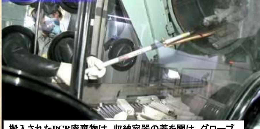
搬入されたPCB廃棄物は、収納容器の蓋を開け、グローブボックス内で異物や可燃物が入っていないか等、内容物の検査を行い、汚染物の種類ごとに詰め替えられます。
