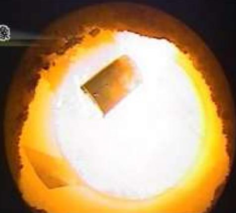
プラズマ溶融分解炉に投入されたPCB廃棄物は、約1400℃の高温にて、溶融分解し無害化処理されます。
