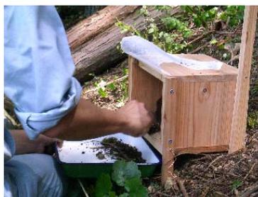
土砂受け箱を設置して表土の移動量を調査
