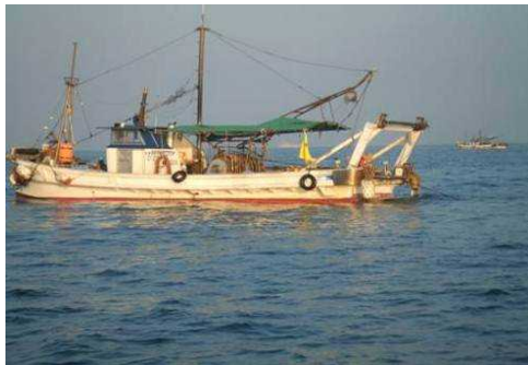
小型漁船による海底耕耘 (右:海底耕耘に用いる桁)
