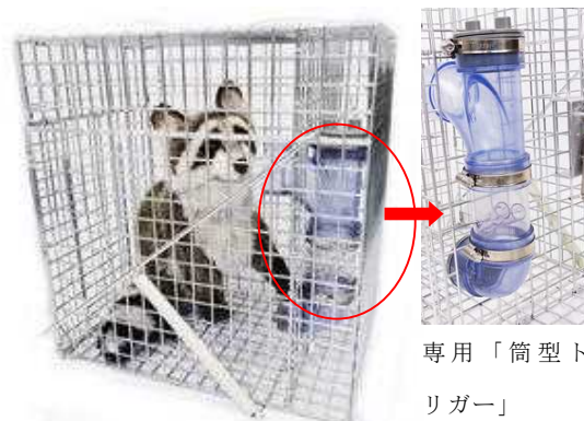
アライグマ専用捕獲わな（写真：㈱地域環境計画） ※前肢で器用にエサを取るアライグマだけを捕獲して、タヌキやネコなどを誤って捕獲しない専用わな
