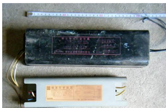
PCB 油含有廃安定器
