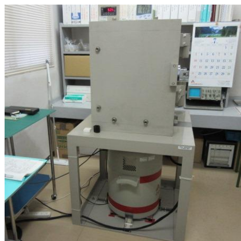
降下物等の放射性物質を測定する ゲルマニウム半導体検出器
