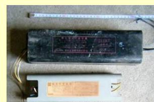
PCB 廃棄物(安定器)
